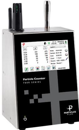
Der Partikelzähler 7301 ermittelt die Anzahl von Partikeln zwischen 0,3 und 25 µm mit einem Probenahme-Volumenstrom von 2,83 Ltr./min (0.1 CFM) und gehört unter den aktuell verfügbaren Remote Partikelzählern zu den am vielseitigsten einsetzbaren Geräten.
